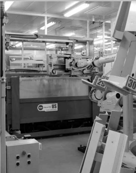
超音波洗浄ユニットにロボットアームがシリンダーを入れるところ。大三紙業のラインには超音波洗浄ユニットが2つ組み込まれている
