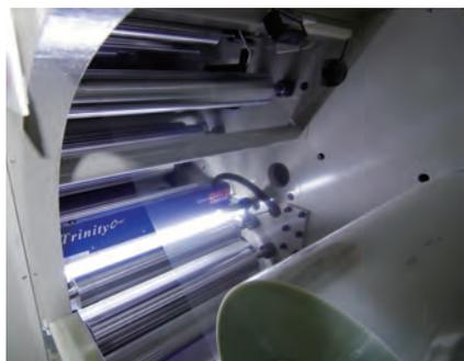
青い部分が、ダックエンジニアリングのフルカラーのバリアブル印刷検査装置『Trinity digi』のカメラユニット
