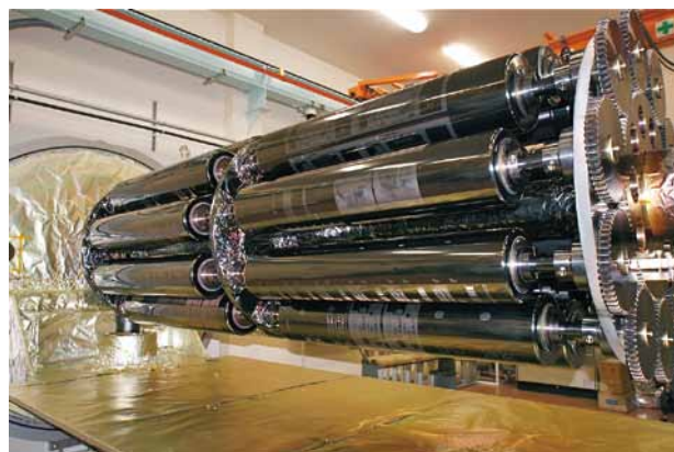
大型DLC成膜装置でのシリンダー20本対応
